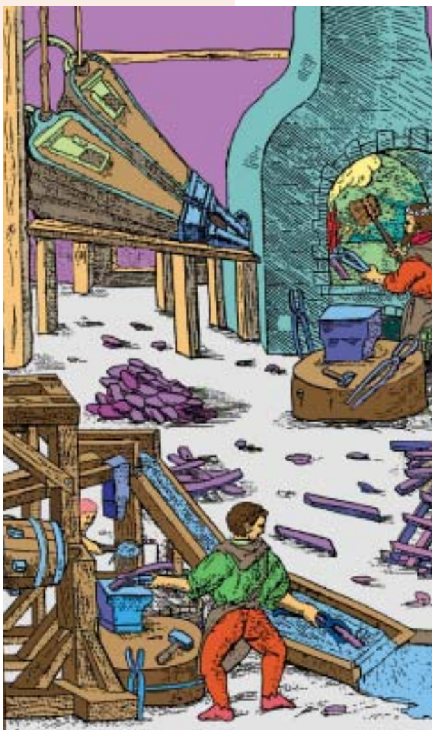
Ferrería del siglo XVI. Al fondo se hallan los barquines, muy elaborados. Los ferrones llevan un delantal de cuero, con peto, embozo y gorro en una sola pieza, dejando al descubierto los brazos, lo que les dota al mismo tiempo de protección y movilidad.
