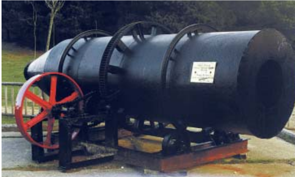
Tromen para lavado de mineral, del año 1940. En el Museo de Peñas Negras.
